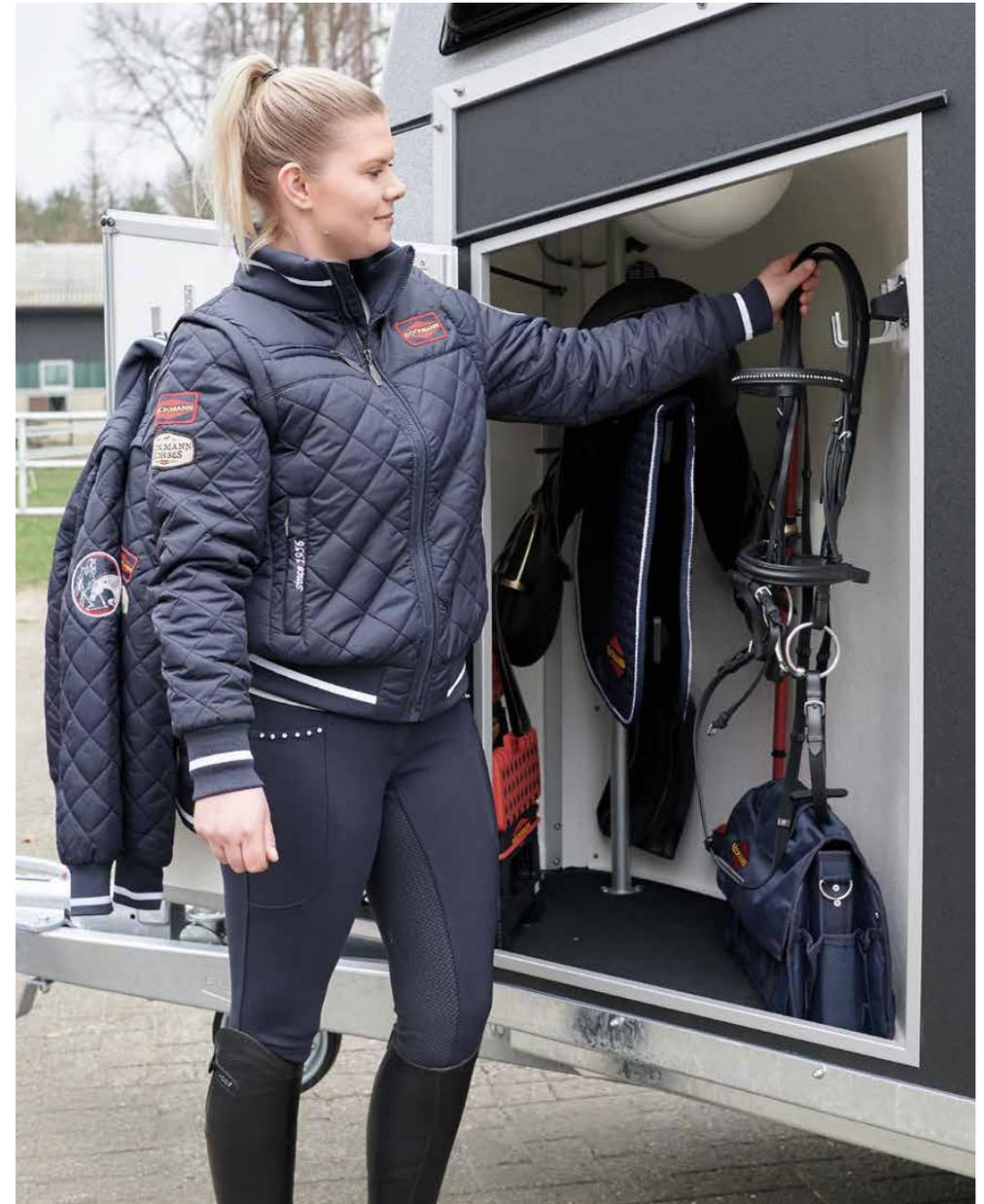
**Sattelkammer Duo R** mit Ablagefach und umfangreicher Serienausstattung: ausziehbarer Sattelhalter, Teleskopbesen, Kunststoffschaufel, Türnetz, Spiegel, Gertenhalter, große Trensenhaken und LED-Licht.
