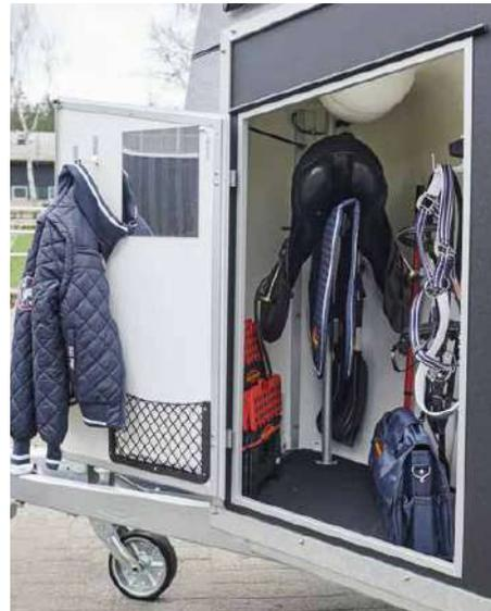
**Alles bequem von außen zugänglich** durch die große Sattelkammertür. Optimales Verschießen durch die 3-Punkt-Türverriegelung und die Gummidichtung.
