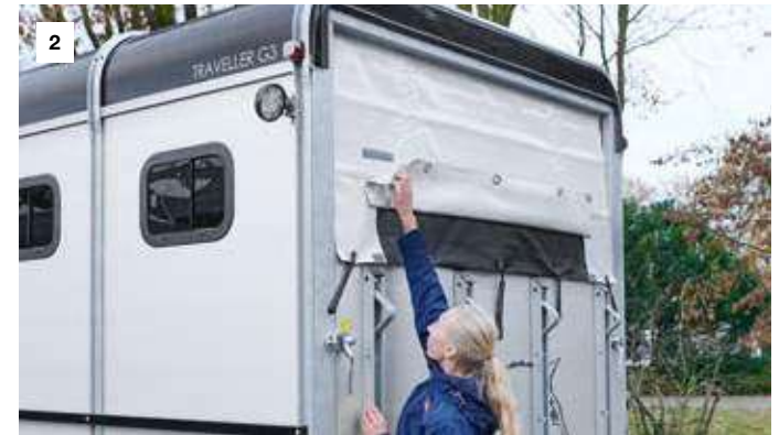
Planenlift mit automatischer Aufrollfunktion [1] und integriertem Netz [2].
