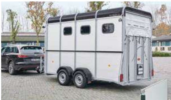
Robuster Aufbau aus eloxiertem Aluminium Doppelstegprofil für Sicherheit und eine lange Haltbarkeit.
