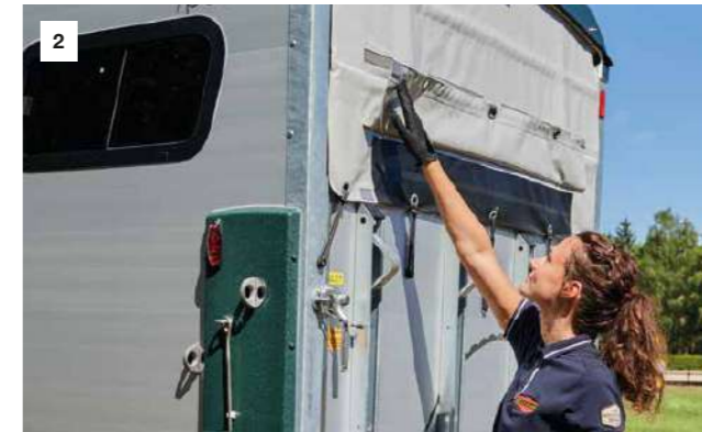
Planenlift mit automatischer Aufrollfunktion [1] und integriertem Netz (nicht bei den Big Portax Modellen) [2].
