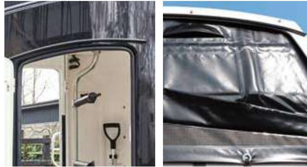
Schutz vor Regen durch die Regenleisten oberhalb der Türen und auch im Heckbereich.
