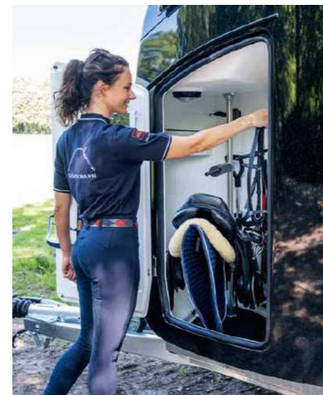
Sattelkammer von außen zugänglich mit praktischen Ablagemöglichkeiten wie 1 Regalboden. Neben den in der Höhe horizontal und vertikal verstell- sowie ausziehbaren Sattelhaltern sind Teleskopbesen, Kunststoffschaufel, Türnetz, Spiegel, Gertenhalter, große Trensenhaken, Padhalter, LED-Licht und Klapphocker mit Sicherung Teil der Serienausstattung.
