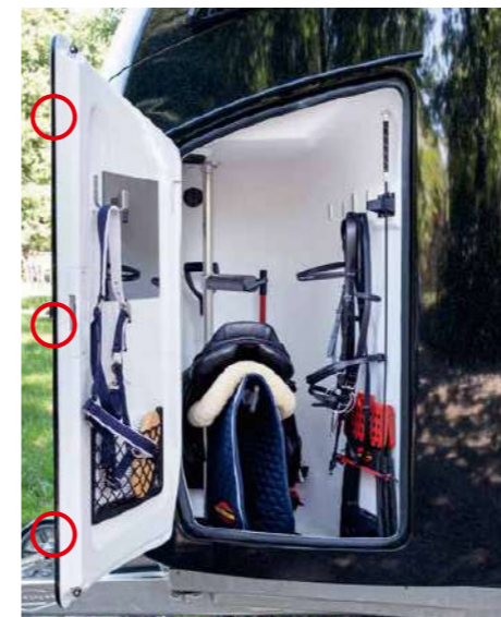
Alles bequem von außen zugänglich durch die große Sattelkammertür mit Regenrinne. Optimales Verschließen durch die 3-Punkt-Türverriegelung und die Gummidichtung.
