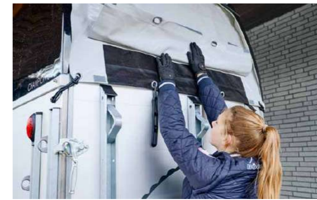
Planenlift mit integriertem Netz und Aufrollfunktion.
