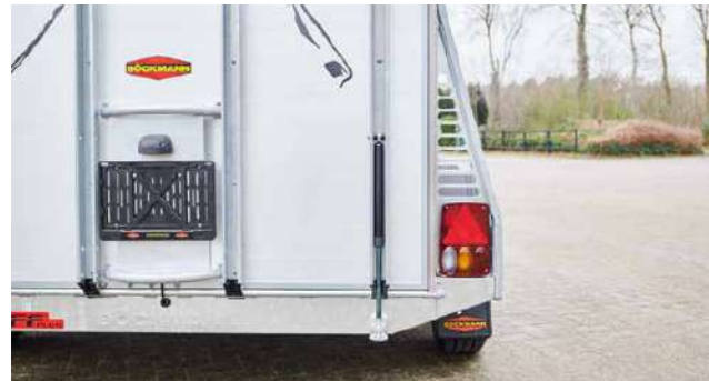
Kein Durchrutschen des Pferdehufs und gute Sicht aus dem Auto durch geschlossene, spezialgelochte Heckstreben.
